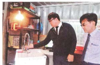
智慧儲能節水裝置可感測使用者的手掌距離，控制出水的流量。(記者劉婉君攝)
